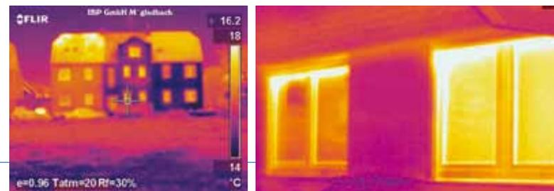
*La risposta ce la dà la termografia: le finestre vecchie (gialle) cedono molto calore*
